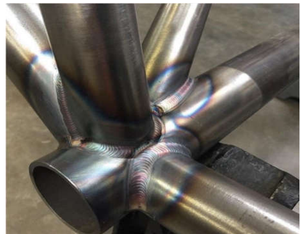
Hình 1. Các chi tiết có biên dạng mỗi hàn phức tạp [2]
